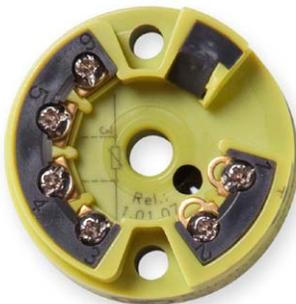
Estos transmisores de temperatura universales (convertidores de medición) son incorporados en los cabezales de conexión del termoelemento. Sirven para convertir una serie de señales de entrada provenientes de los puntos de medición de los termopares o de los termómetros de resistencia en señales estándar estables. Dependiendo del tipo de señal de entrada la tensión tiene en este caso valores de 4 a 20 mA.
