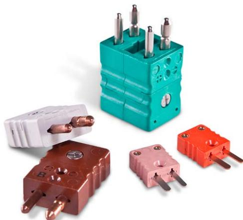
Los conectores y acoplamientos de conexión se utilizan en circuitos de medición en termoelementos y en termómetros de resistencia. Los puntos de contacto son elaborados del mismo material que el termoelemento o el termómetro de resistencia.
