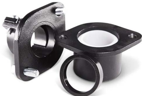
Las bridas sirven para armar el sensor de temperatura en las paredes, en el lugar de aplicación del sensor. La brida de bloqueo es soldada en la pared del punto de montaje, formando de esta manera un fácil y estanco punto de fijación con la brida de montaje.
