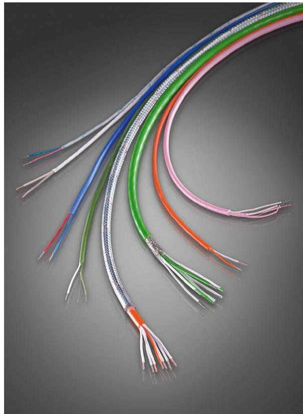
Para termopares de tipo B y en rango de temperaturas hasta 100 °C se pueden usar conexiones de cobre. Por ello para este tipo de alambres de compensación la norma DIN 43 722 no prevé límites de precisión. Si los cables de compensación para el tipo B se utilizasen en temperaturas más altas hará falta emplear cables de compensación especiales. Este tipo de alambres son disponibles por encargo.
