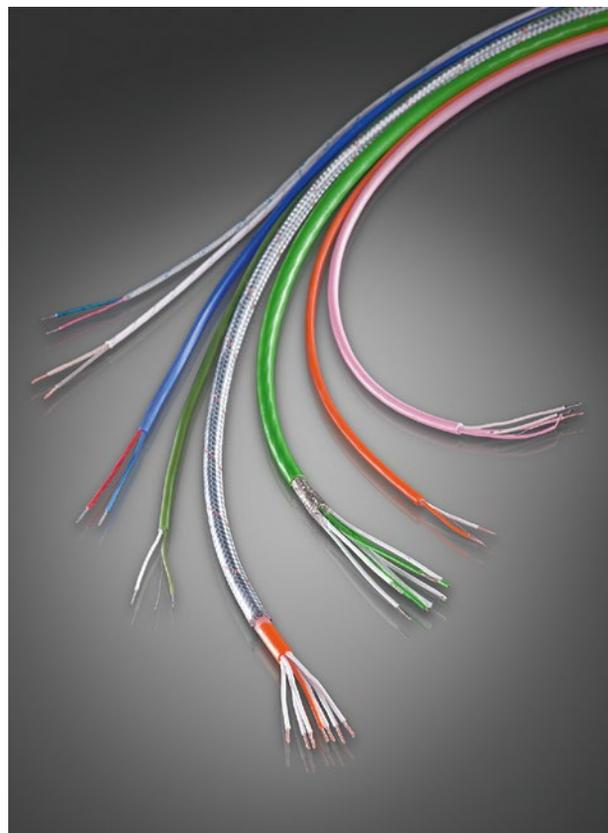
Für das Thermopaar Typ B können im Temperaturbereich bis 100°C Kupferleitungen verwendet werden. Deshalb sind in DIN 60584-3 keine Grenzabweichungen für diese Ausgleichsleitungen vorgesehen. Müssen Ausgleichsleitungen für Typ B bei höheren Temperaturen eingesetzt werden, ist die Verwendung einer speziellen Ausgleichsleitung notwendig. Diese Leitungen sind auf Anfrage lieferbar.
